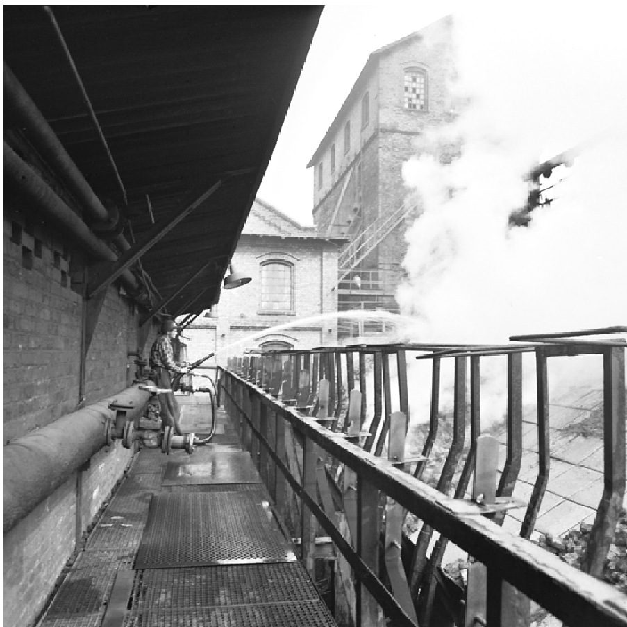
Gaszenie koksu na rampie skośnej, lata 60. XX wieku, ze zbiorów JSW KOKS Zabrze
