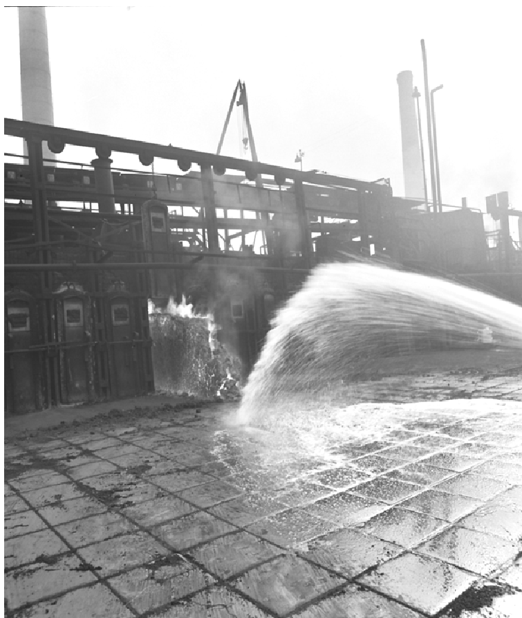
Wypychanie koksu na rampę płaską, lata 60. XX wieku, ze zbiorów JSW KOKS Zabrze
